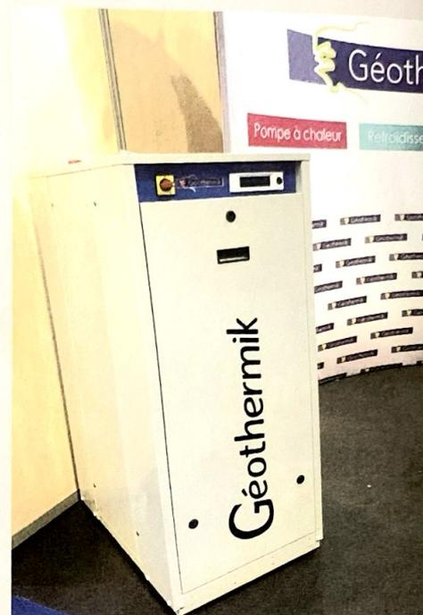
catalogue comprend des modèles de 4 à 250 kW, et au-delà sur mesure. Créé en 2005, ce fabricant propose également une gamme de déshumidificateurs, de refroidisseurs à condensation par eau et par air, ainsi qu'une Pac air/eau monobloc fonctionnant au R290. En photo : le modèle haute température **ULTRA** (60/65 °C), avec compresseur EVI bi-étagé, échangeur tubulaire Inox pour eau de nappe et régulation électronique (également disponible en version Aqua+ délivrant une eau à 50/55 °C).
